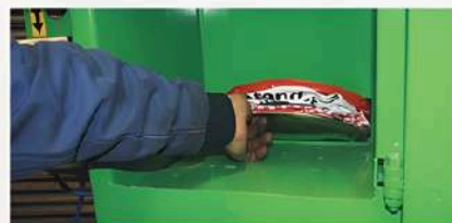
Retrait facile des bidons après compactage et collecteur de liquide
