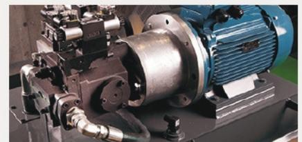
Moteur 18,5 kW pour un compactage optimal des balles et un meilleur rendement énergétique grâce au refroidisseur et au réchauffeur d'huile de série
