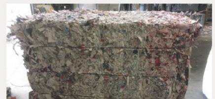
Des balles d'une tonne réduisant les besoins énergétiques, de main-d'œuvre et de consommables
