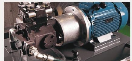
Moteur 18,5 kW pour un compactage optimal des balles et un meilleur rendement énergétique grâce au refroidisseur d'huile et au réchauffeur d'huile
