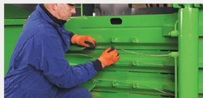
Le système d'attache aisé à 4 ligatures garantit que la balle reste compactée
