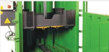
Force de compactage réelle de 50 tonnes et vérin à course longue pour une force de compactage maximale produisant des balles de 400 à 500 kg
