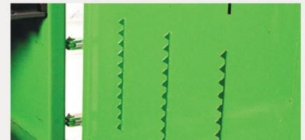
Configuration unique intégrant des doigts de retenue mobiles et fixes pour un compactage optimisé
