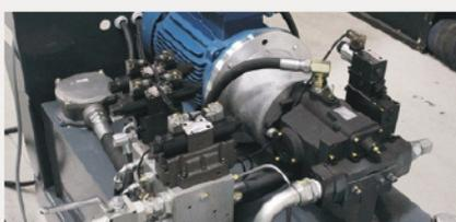
Le bloc d'alimentation 15 kW assure un fonctionnement rapide et les vérins à course longue une force de compactage optimale
