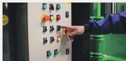
Possibilité de sélectionner deux tailles de balles à l'aide d'un simple interrupteur
